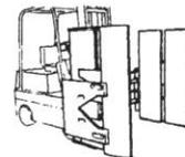
9. **Garra universal:** é um dispositivo que permite girar (em 90°) os garfos da empilhadeira, transformando-os em garra. Opera tanto com paletes como com fardos, ou para condicionar uma camada de paletes.
