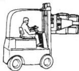
4. **Empurrador/Puxador de carga:** dispositivo provido de um pantógrafo que desliza sobre a plataforma de apoio. Utilizado para colocar cargas em estruturas de dupla profundidade ou caminhos. Este acessório é dispensar o uso de paletes comuns, operando com uso de folha rígida.
