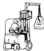
20. **Caçamba basculante:** os garfos são substituídos, ou sustentam, uma caçamba que permite carregar e descarregar materiais a granel. Usado em fundições. Pode ser operada hidráulica ou mecanicamente.
